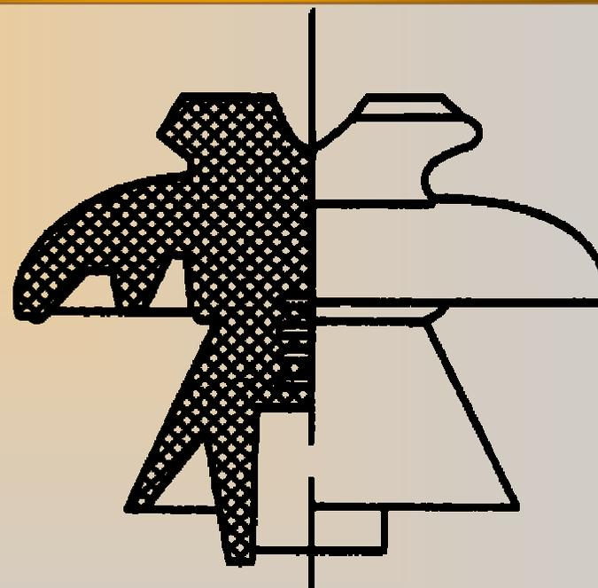
图 2-4 针式绝缘子
